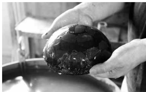
写真7. 研磨皿に松ヤニを使ってレンズを装着している様子（2014年撮影）
