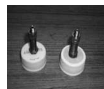
図2 自作した空気捕集容器 ペットボトルの蓋に自転車用の バルブと虫ゴムを取り付けた
